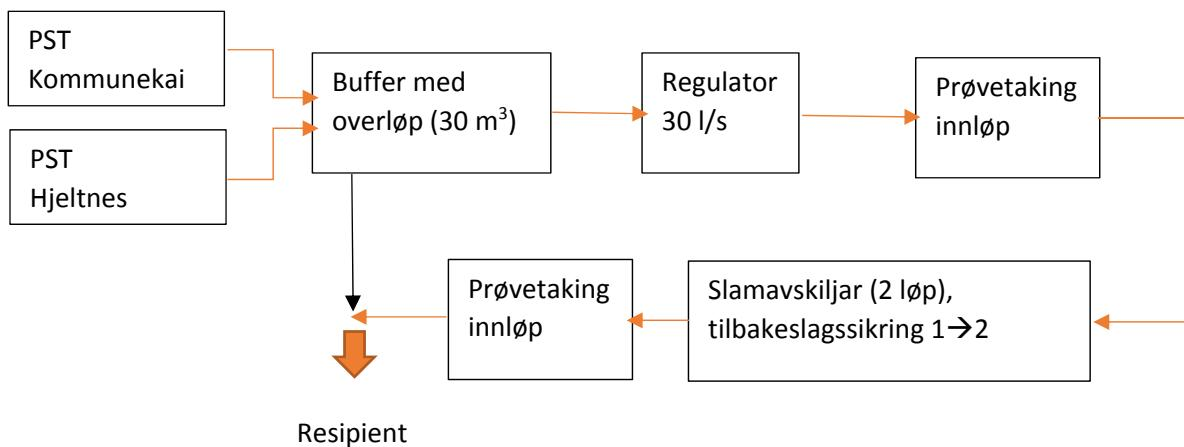
Samla tilførsel er kring 20 l/s i tørre og kring 50 l/s i nedbørsrike periodar. Regulator gjorde at volum betre kunne tilpassast, og lagt til grunn at mindre enn 5% av tiden skal ha overløp, og at slamavskiljar ikkje vert «flusha» og man får slamflukt.
