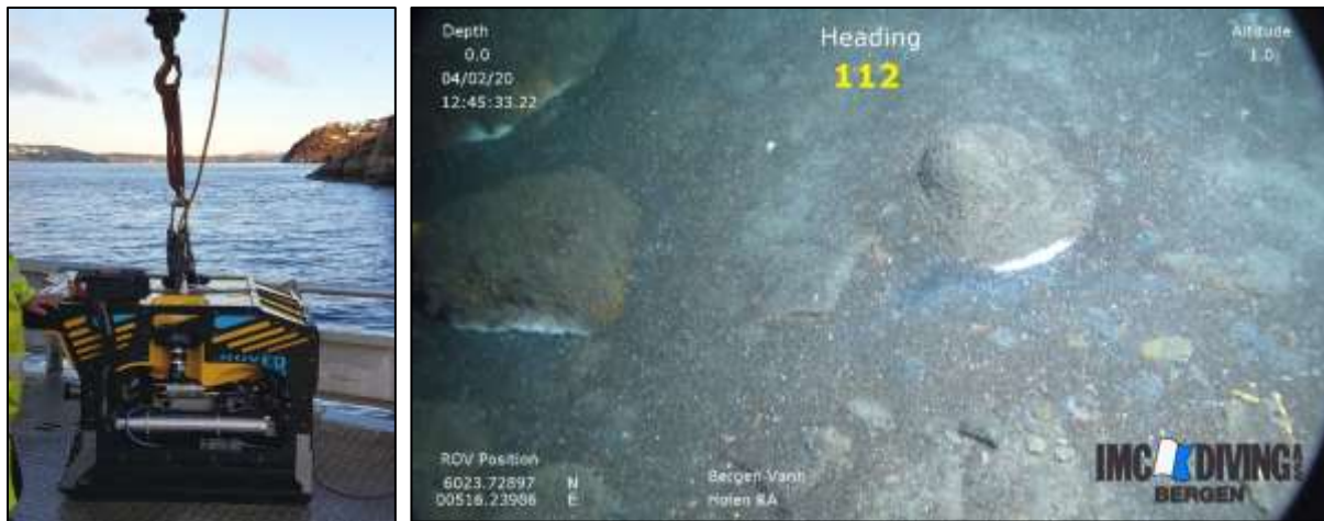
Figur 7. Til venstre: IMC-Diving sin ARGUS Rover ROV. Til høyre: Sjøbunn med tydelig påvirkning ved Hølen renseanlegg.
