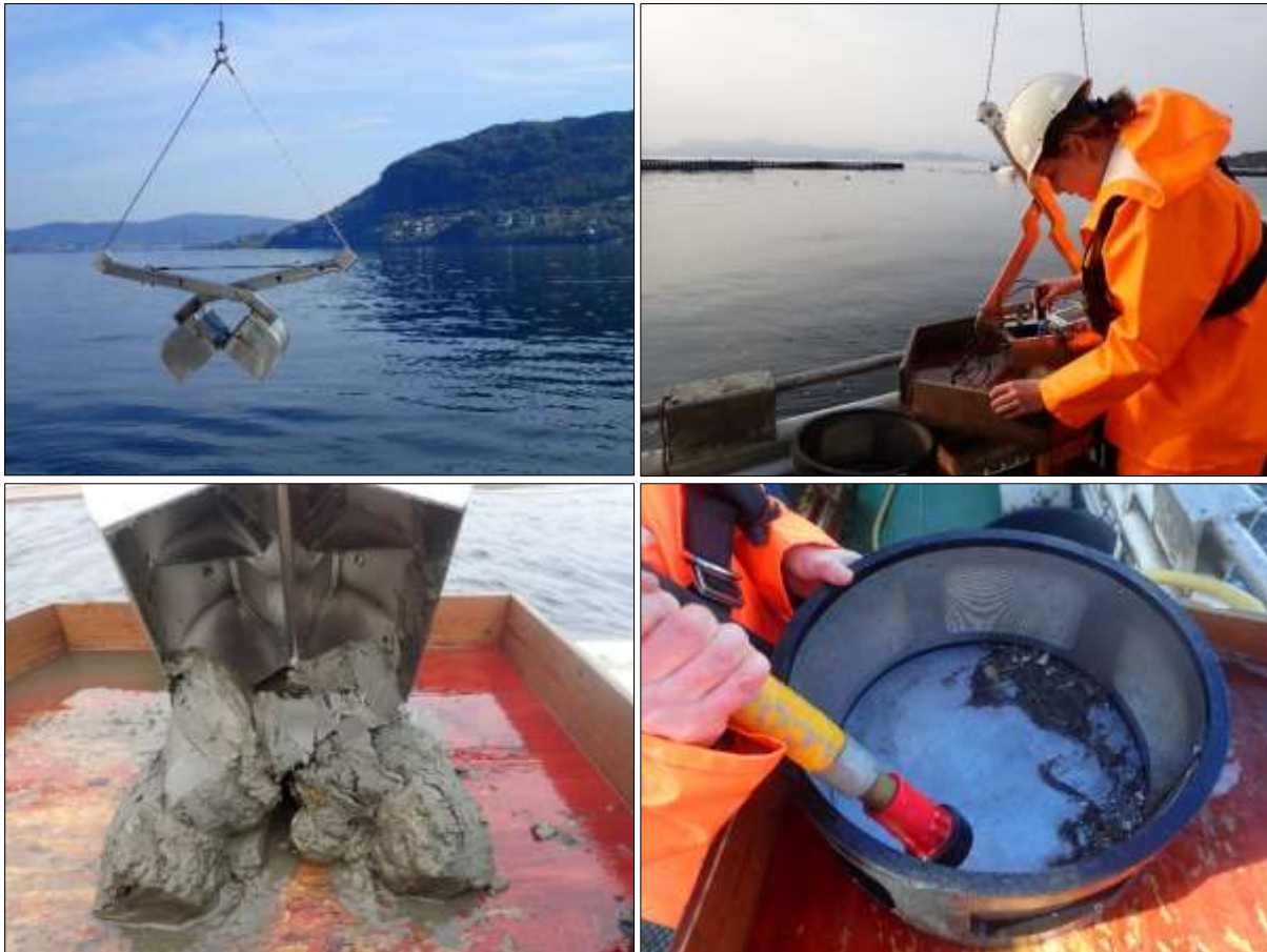
Figur 5. Øverst t.v.: grabben før den blir sendt ned for å ta prøve. Øverst t.h.: Måling av pH og redokspotensiale i sedimentoverflaten. Nederst t.v.: Sedimentprøve på spylebord. Nederst t.h.: Dyr og sediment som er igjen etter en har skylt vekk sediment og organismer som er mindre enn 1 mm.
